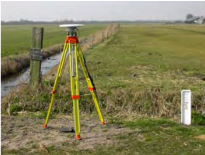
Meetpunt van de Rijksdriehoeksmeting met een GPS-ontvanger.
