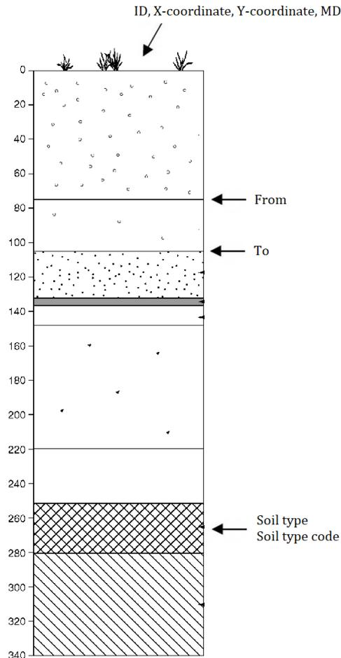
**Figure B.4:** Drilling data parameters
