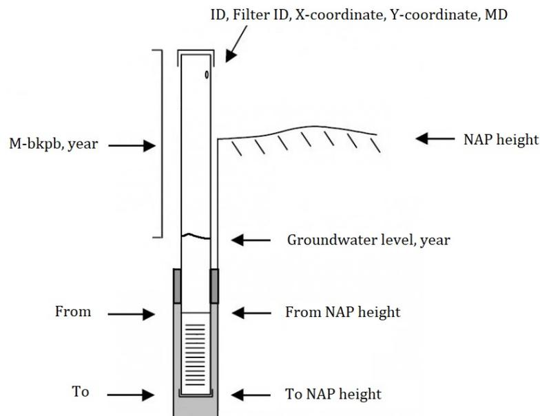
**Figure B.3:** Well data parameters
