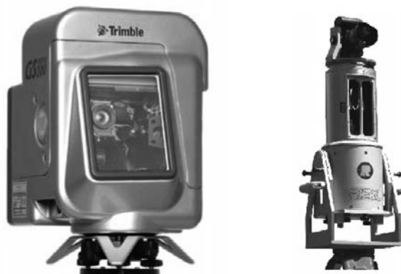
Nieuwe generatie laserscanners: (links) Mensi GS200, (rechts) Riegl LMS-360i.
