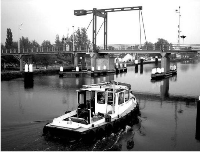
Een kinematische meetproef op de Schie tussen Delft en Overschie, met een groot aantal GNSS-antennes en -ontvangers achter op het dek en boven op de kajuit.
