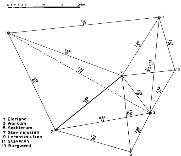
Fig. 2.1.7. The standard deviations  $\ln s_{ij}$  and  $s_{ij}$ .
