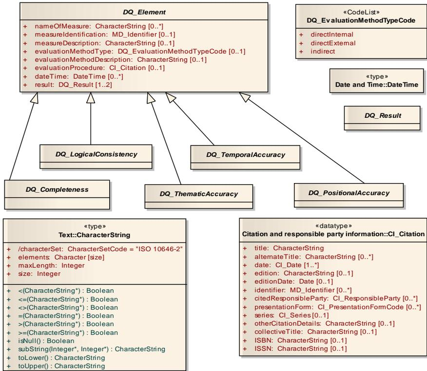
Figure 45 DQ\_Element from ISO 19115 (ISO/TC211, 2003c).
