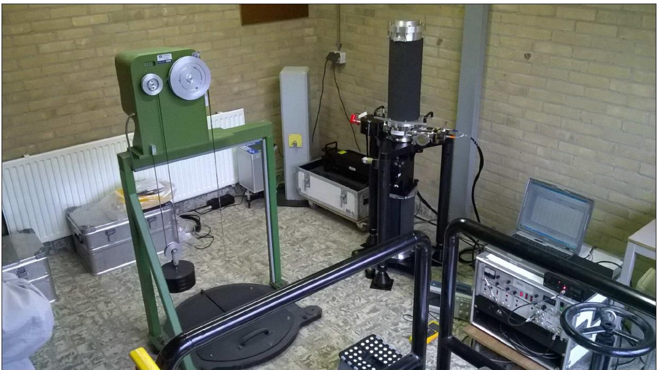
Figuur: Zwaartekracht meting in de technische ruimte van getijdestation Oudeschild. In de foto zijn de getijdemeter, absolute zwaartekrachtmeter en NAP-peilmerk zichtbaar. Aan de buitengevel van de ruimte is de antenne van AGRS-station TXE2 geplaatst.
