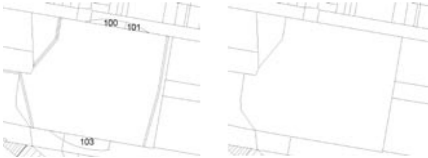
Figuur 4. Kadastrale kaart met (a) en zonder (b) footprints van de 3D-percelen 100, 101 en 103 (en met en zonder de geometrie van erfdiensbaarheden).
