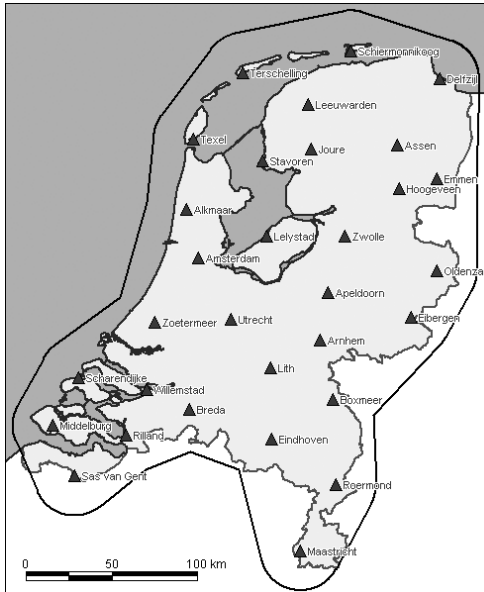
De referentiestationen van NETPOS (Netherlands Positioning System) en de dekking van het systeem.
