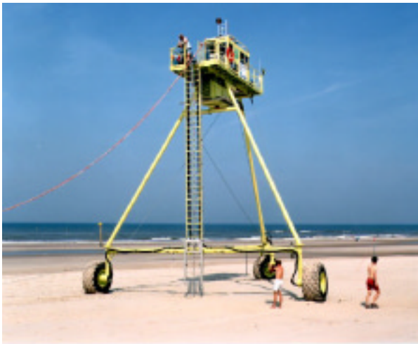
De WESP (Water En Strand Profiler), het voertuig van Rijkswaterstaat waarmee kust- en strandprofielen kunnen worden gemeten.
