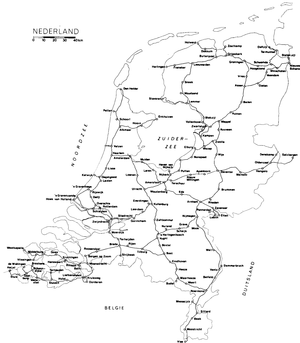
Fig. 3 Overzicht van het net van de eerste nauwkeurigheidswaterpassing. Plan of the first geodetic levelling network.
