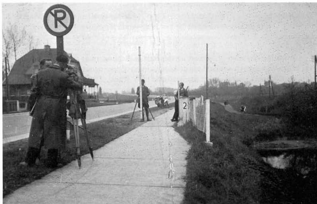
Fig. 40 De „laatste” slag (Limburg 1939). Achter het Zeiss-instrument G. v. D. HOUVEN. De lange baak is het laatste tussenpunt; vandaar wordt een extra slag gemaakt naar de opzetbaak die op het peilmerk in het muurtje (bij het cijfer 2) wordt gehouden.
